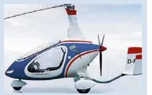
Tragschrauber sind eine Mischung aus Hubschrauber und Flugzeug. FOTO: AUTOGYRO
